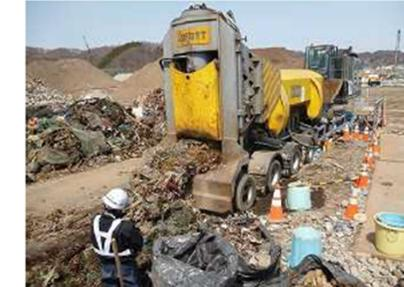
ギロチン式裁断機を用いた裁断例
