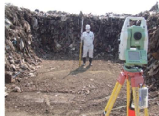
・廃棄物の性状等から場所を選定し、区画を切り抜き、その廃棄物の重量と切り抜いたエリアの体積を計測し算出した。
